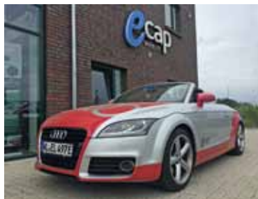
Fährt sich wie ein echter TT: Nach dem E-Umbau muss gekuppelt und geschaltet werden, der Motor ist aber emissionsfrei.
