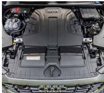
Drei-Liter-Turbodiesel: Der Q8-Motor leistet 286 PS.
