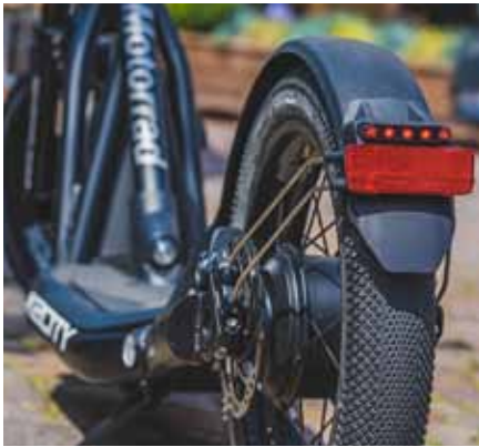
Hydraulische Scheibenbremsen, stabiler Rahmen, breite Reifen: Der X2City fährt nicht nur gut, er bremst auch so.
