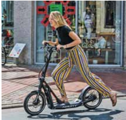
Hydraulische Scheibenbremsen, stabiler Rahmen, breite Reifen: Der X2City fährt nicht nur gut, er bremst auch so.
